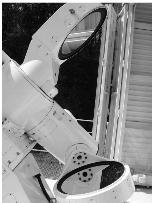
Obr. 2. Coelostat typu Jensch, průměr dvou plochých zrcadel je 60 cm. Coelostat je chráněn před nepřízní počasí odsuvnou plechovou střechou.
