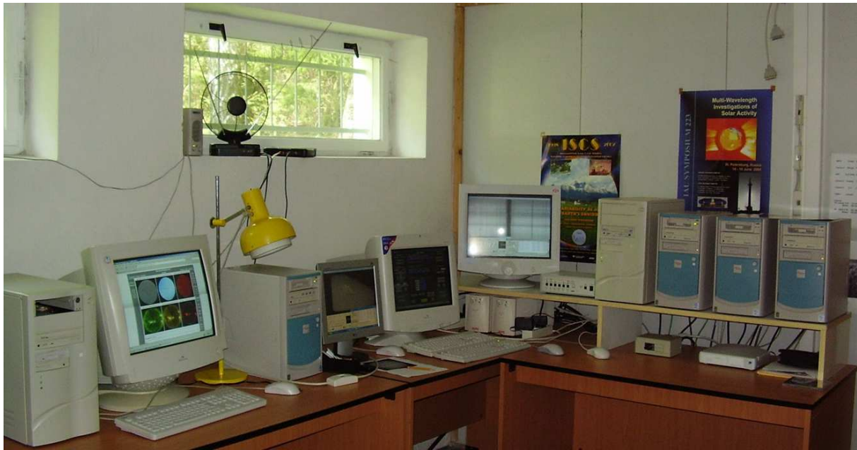
Obr. 7. Na rozdíl od uspořádání pracoviště před rekonstrukcí, kdy pozorovatel ovládal spektrograf z blízkosti šterbiny, nyní je dislokován v suterénu pavilónu, kde má k dispozici všechny ovládací elementy a potřebný pracovní komfort.
