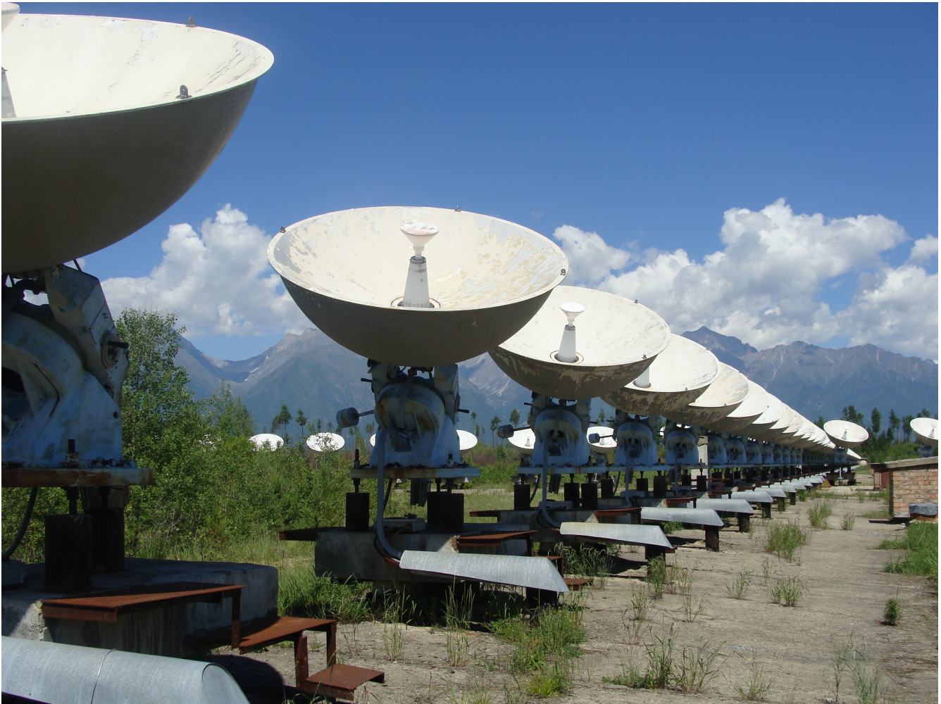
Obr. 28: Část antén radioheliografu ISTP Irkutsk v Badarech před započatím rekonstrukce. V té době fungoval interferometr na principu zkřížených anténních řad, s využitím multifrekvenční syntézy. Nyní se přestavuje na přístroj s aperturní syntézou.
