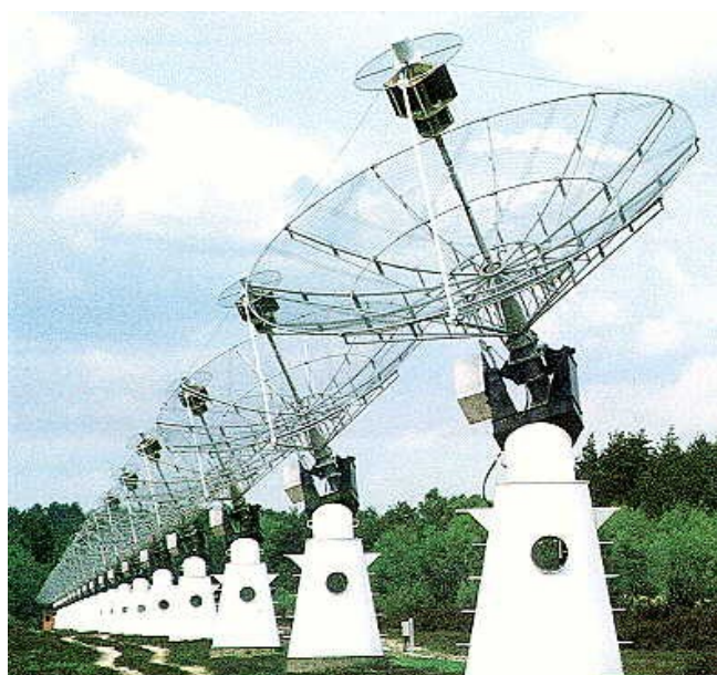
Obr. 11: Část interferometru používaného pro výzkum Slunce (tedy radioheliografu) ve francouzském Nancay. Tento přístroj je typickým zástupcem ekvidistančních anténních řad.
