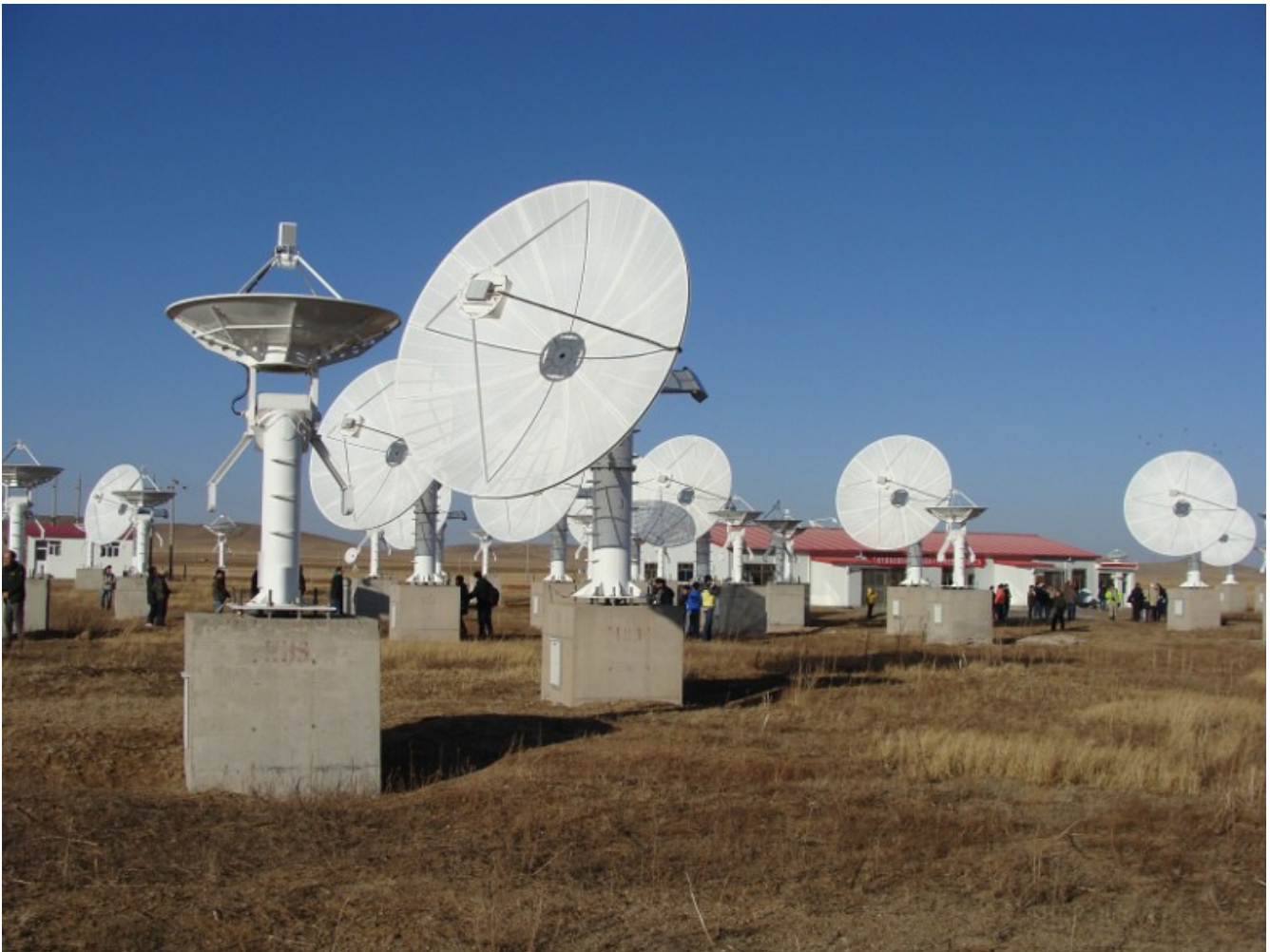
Obr. 29: Centrální část právě budovaného spektro-radioheliografu CSRH v horské stepi v čínské provincii Vnitřní Mongolsko. Budova v pozadí ukrývá i srdce přístroje - dedikovaný rychlý počítač / korelátor.
